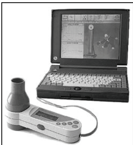
Slika 36. Moderni prenosivi spirometar podesan za rad i u kućnim uslovima ( Vitalograph Spirometry, MedexMedical )
